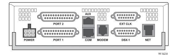
Figure 1-4. 3160 DSU/CSU Rear Panel
